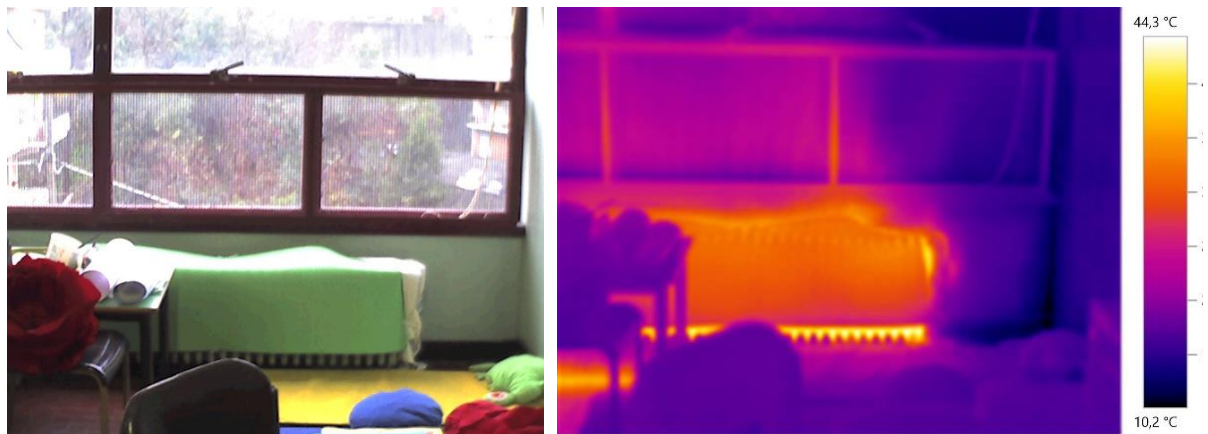
Figura 4.4 – Rilievo termografico dei serramenti
